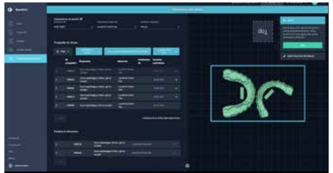
Rys. 6: Umieszczenie nakładek wybielających na platformie drukarki 3D
